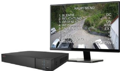
Die Kamera unterstützt UTC (Up The Coax). So können Sie in Verbindung mit einem kompatiblen Recorder oder mit einer passenden Einstelleinheit das Bildschirmmenü der Kamera auch über die Videoleitung konfigurieren. Es ist keine zusätzliche RS485 Verbindung erforderlich.
